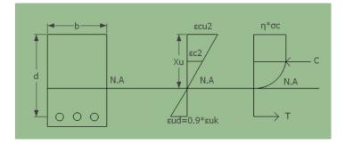
FIG-1 STRESS-STRAIN DIAGRAM
